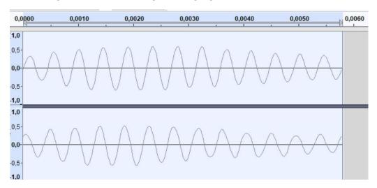
Es ist klar, dass die Schwebungsfrequenz die Frequenz des Grundtons und die Frequenz der kleinen Sinusschwingung die des Obertons ist - der erwartungsgemäß 13 Mal in die Schwebungspüeriode passt.
